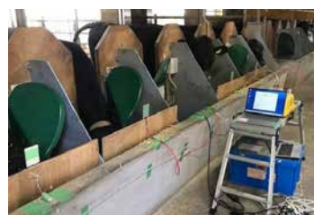
肥育牛の呼気中のメタン濃度測定(附属牧場にて)
