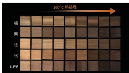
古い木材を熱処理によって人為的に再現する試み
