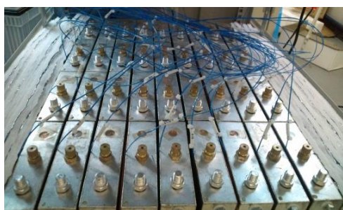
図1 イオン液体を用いたナトリウム電池
