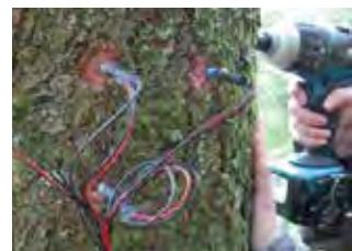
ヤマザクラの幹に取り付けられた樹液流速度計測センサー。
