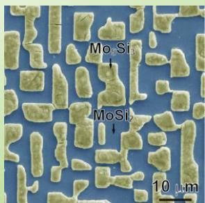
MoSi<sub>2</sub>/Mo<sub>5</sub>Si<sub>3</sub>ラビリンス合金の微細組織
