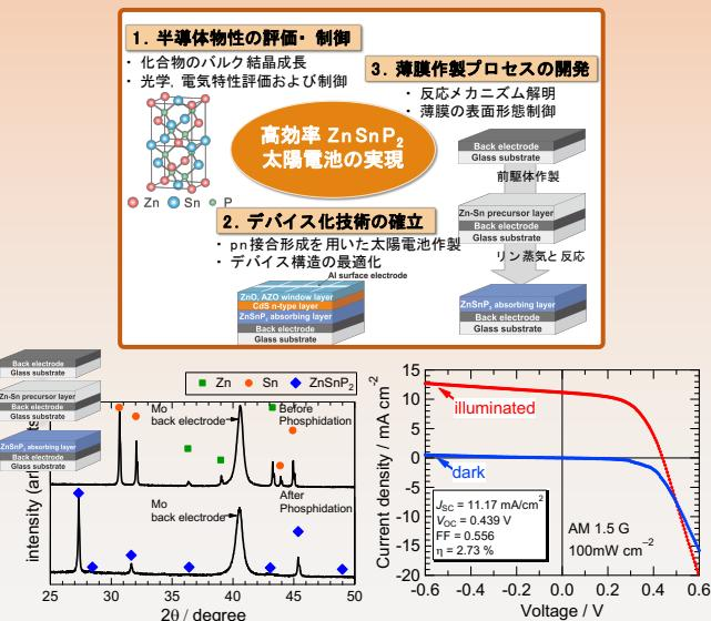
Zn-Sn膜のリン化反応を利用してZnSnP<sub>2</sub>膜の作製に成功。ZnSnP<sub>2</sub>太陽電池が発電することを世界で初めて確認。
