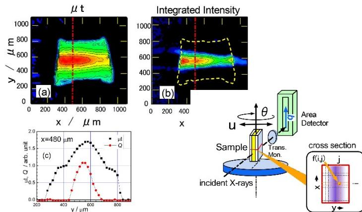
三次元の複合材内部でナノ構造がどのように分布しているのかを非破壊計測する手法を開発しています。複合材を壊さず特性予測する設計評価法につながります。
