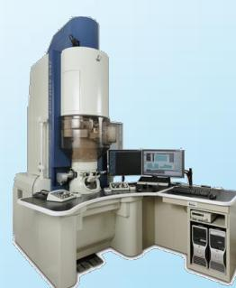
球面収差補正走査透過電子顕微鏡 (Cs-corrected STEM)
