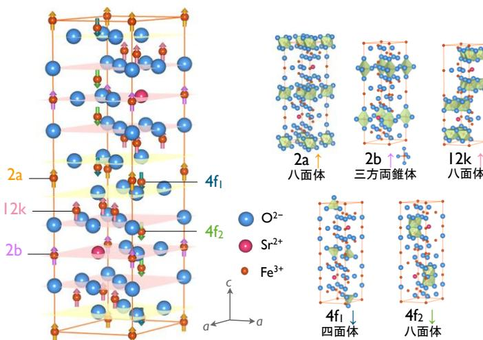
永久磁石材料M型Srフェライトの結晶構造
