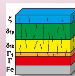
合金化溶融亜鉛メッキ鋼板 のメッキ被膜の模式図
